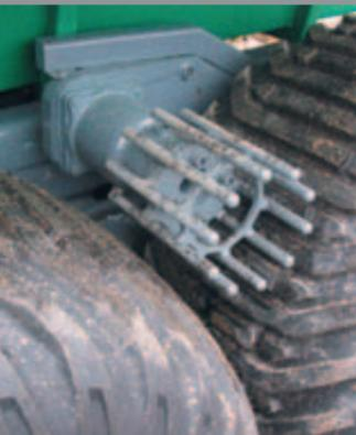
Hydraulisk boggedrift och bromsar kan erhållas som extrautrustning.
