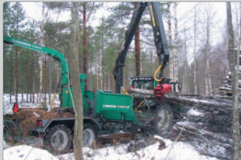
Alla 4560C-huggar är standardförsedda med ett integrerat hydrauliskt system. High-flow-pumpar inmonterade i stödbensramen finns som tilläggsutrustning för att ytterligare garantera kranens effektiva funktion.
