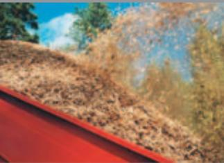
Kesla Foresteri-huggen producerar flis av jämn kvalitet. Flisproduktionen når upp till 160m<sup>3</sup>/h (beroende på råmaterial och förhållanden).
