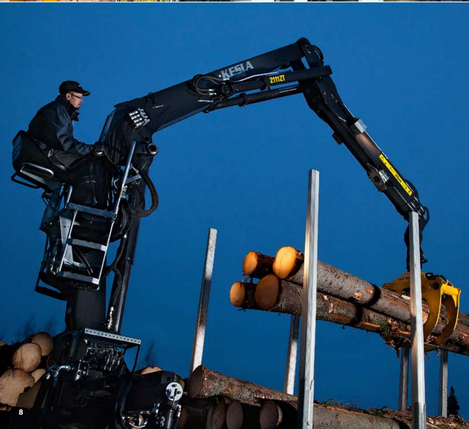
Keslan Z-nosturimallisto alkaa kevyestä 5 tonnimetrin mallista ja ulottuu aina 19 tonnimetriin saakka. Kesla on viime vuosina panostanut voimakkaasti Z-nostureiden tuotekehitykseen, minkä tuloksena on syntynyt huippumoderni 21-sarja. Uusia ominaisuuksia ovat mm. täysin sisäpuolinen hydraulikkaputkitus ja -letkutus, nyt myös nostopuomissa.
