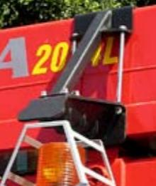
Kokorunkojen käsitteilyä helpottava tukkivaste on asennettavissa nostopuomiin ja nosturi mallista riippuen lisäksi siirtopuomiin.
