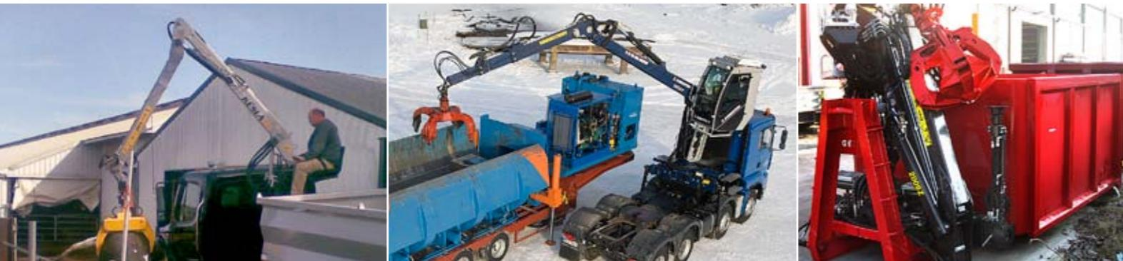
Koko laaja KESLA-nosturimallisto voidaan varustaa monipuoliseen kierrätysmateriaalien käsittelyyn. Ohjausjärjestelmässä on kaksi varustelutasoa, täysin sähköinen ohjelmoitava hallintajärjestelmä radio-ohjauskella sekä radio- ja mekaanisen ohjauksen yhdistelmä. Molemmissa vaihtoehtoissa on huomioitu EU-direktiivien mukaiset turvamäärykset.
