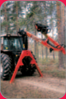
Monteringsalternativ för 200 serien: Monterad i 3-punktlift
